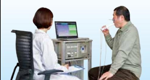
人の呼吸機能情報を一元管理できるマルチ装置です。呼吸流量、呼吸圧力、CO<sub>2</sub>/O<sub>2</sub>ガス濃度の測定により、呼吸系の機能及び効率に関する情報を提供します。
