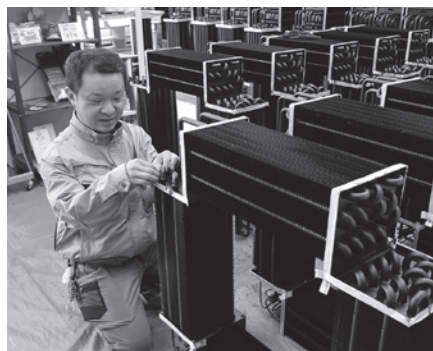
納豆工場で使用している機械の防錆処理
